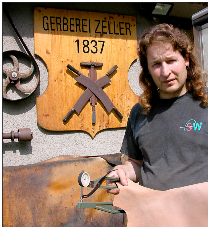
Jürg Zeller hält eines seiner Ziegenleder und eine Zange in der Hand, mit welcher er die Dicke der Häute misst.
